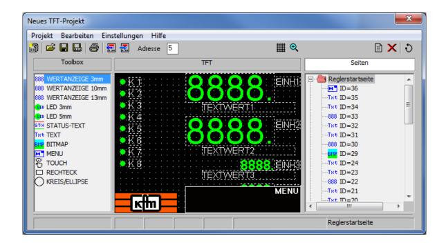
Mit diesem Programm können TFT-Displays der KFM-Baureihe 803 und 903 verändert oder auch von Grund auf neugestaltet werden.
